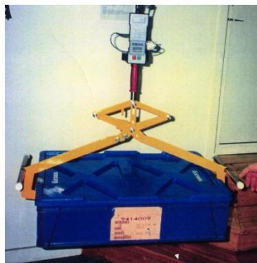
Les pinces pour manipulation de bacs en plastique permettent à l'opérateur de manipuler rapidement les bacs en toute sécurité. L'opérateur ne subit plus les contraintes de poids et de mouvement générées par l'opération.
